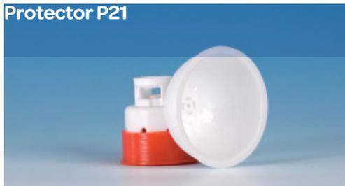
El Protector es un sistema de equalización de presiones, permanentemente conectado al vial, que establece una presión neutral cuando se inyecta aire o líquido o cuando se aspira volumen de vial.
